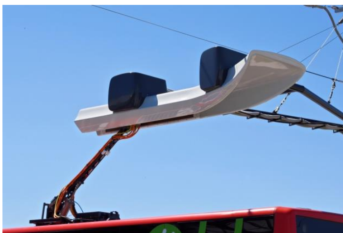
Rysunek 3. Układ ładowania pantografowego dla autobusu elektrycznego projektu EC Engineering Sp. z o.o. 33
